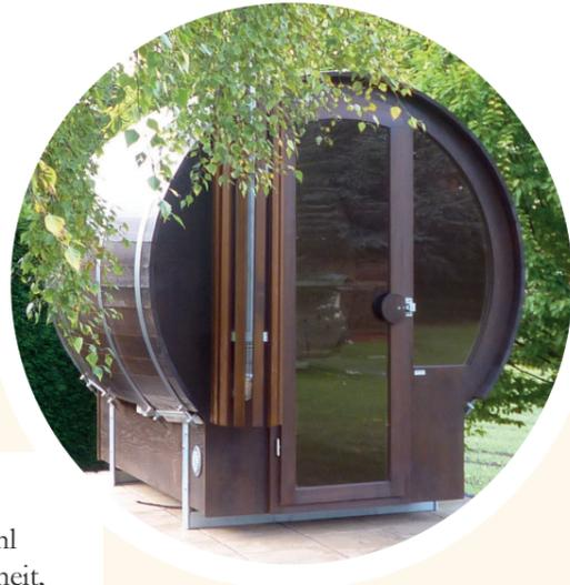
In unserer Tischlerei wird mit höchstem handwerklichen Können jede Daube (Brett in der Außenwand) zu den Enden hin verschmälert, die Seiten angeschrägt und mit Nut & Feder versehen. So entsteht ein wirklich bauchiges Fass mit viel Platz im Innenraum welches allein durch die Konstruktion dicht ist und kein Dach erfordert.
